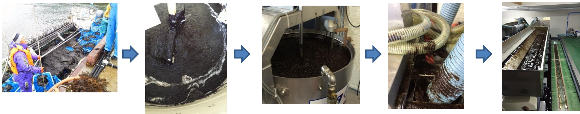
タンクからタンクへと移動し綺麗に洗い、異物の選別もします
