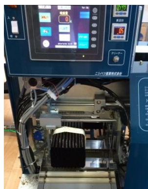
10枚ずつ畳まれ1帖になり更に10帖ずつ束ねて完成!!160分で24,000枚の速さで作られているそうです。
